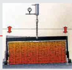
Der Anpressdruck der Hauptkehrwalze wird über ein hydraulisches System konstant gleich gehalten.
