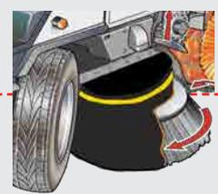
Eine optionale Seitenbesenabdeckung ermöglicht eine vollständig trockene Reinigung.
