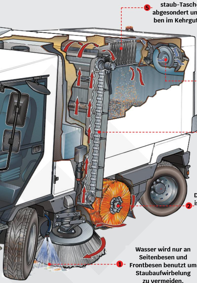
**Selbst feinste Stäube werden über den Feinstaub-Taschenfilter abgesondert und verbleiben im Kehrgutbehälter.**
